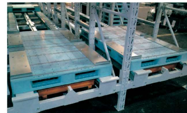
パワーシフター 水平式流動ラック 保管物の先入先出・先入後出の両方向が可能
